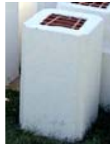
L'élément de pilier après démoulage et grattage.
