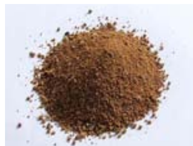
Sable de carrière argileux non lavé
